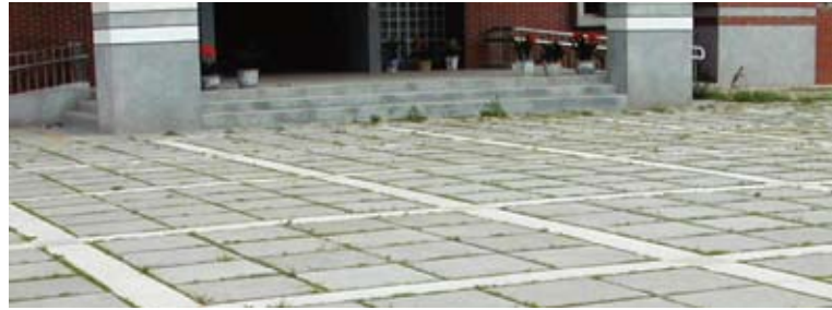
(右) 圖9 透水鋪面增加基地保水功能
